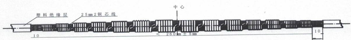
7股铜芯线交叉压线头连接示意图
